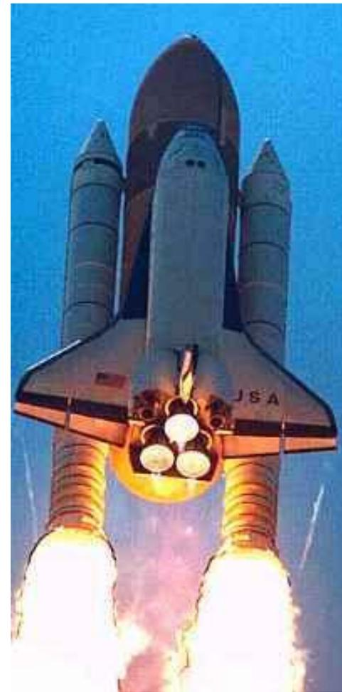
Космический челнок (США) использует жидкое топливо ( $H_2+O_2$ ) и два твёрдо-топливных ускорителя
